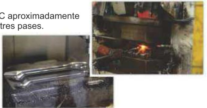
4. Se pasa a normalizar el acero a una temperatura de 850°C en proceso continuo.
