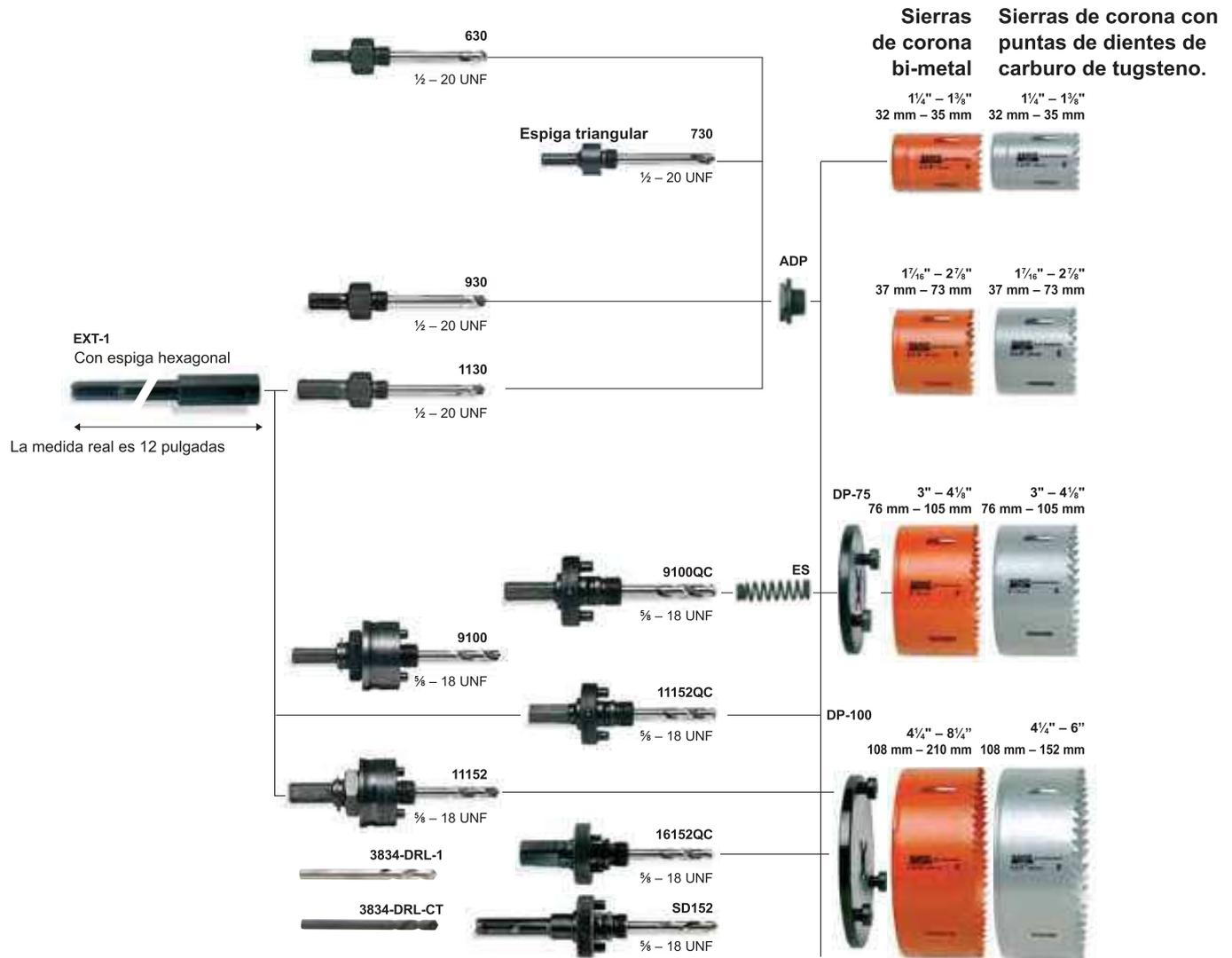
Seleccione el soporte adecuado de acuerdo con el tamaño de la sierra de corona y el tamaño del portabrocas de la taladradora a utilizar. El soporte 3834-ARBR-730, para coronas de 14 a 30 mm, posee una espiga triangular y un cuerpo redondeado. Para diseños más robustos y fácil expulsión de coronas de 14 a 30 mm seleccione soportes con espigas y cuerpos hexagonales, es decir 3834-ARBR-630, -930, -1130.
