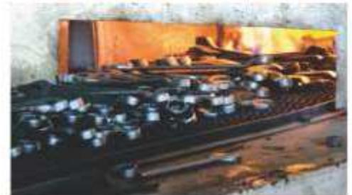
11. El tratamiento de galvanoplastia es un proceso electrolítico que incorpora a la herramienta níquel y cromo para la resistencia anticorrosiva y mejorar el aspecto visual.
