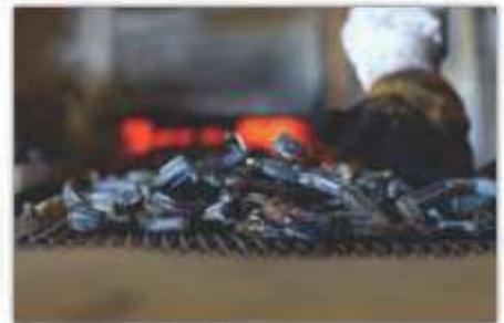
5. A la pieza normalizada se la pasa por la granalla para su limpieza superficial y sacar las deformaciones existentes.
